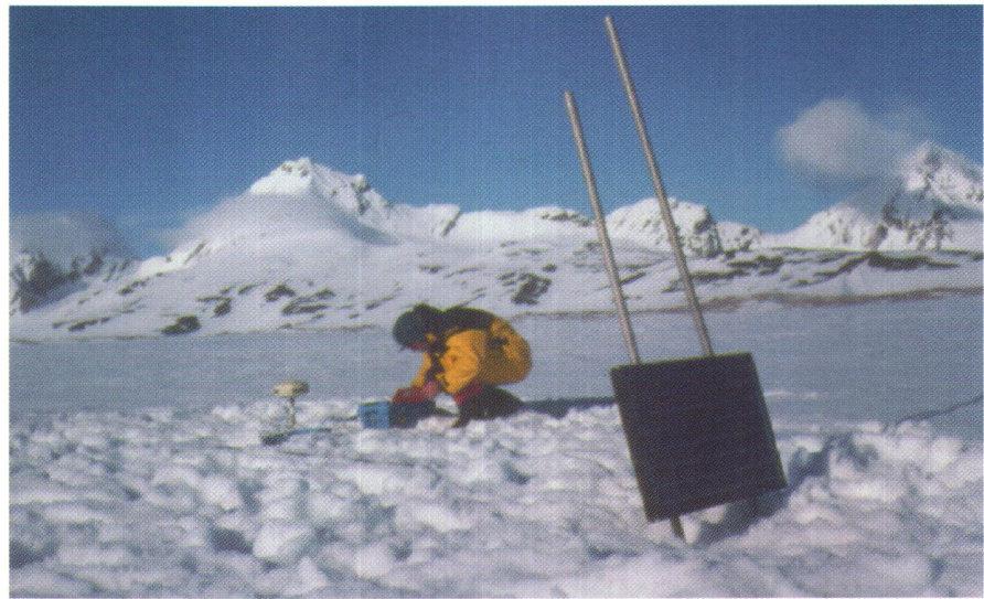
Abb. 3: Pegel Grün mit Solarpanel und dem GPS-Empfänger (Foto A. Vieli).
